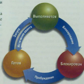
Рис. 1. Диаграмма состояний и переходов процесса. Состояния показаны вершинами графа. Все переходы отмечены дугами с названиями переходов. Отметим, что только переход «блокирование» процесс выполняет по своей инициативе. Остальные переходы происходят независимо от его желания
