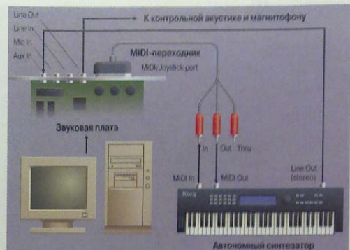
Рис. 2. Схема подключения к звуковой плате автономного синтезатора
