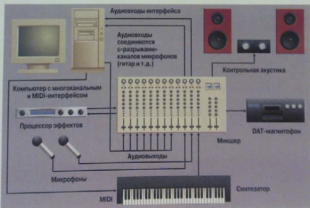
Рис. 8. Схема коммутации компьютерной студии на базе многоканального интерфейса с аналоговыми входами-выходами
